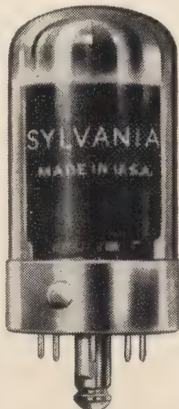
La nueva válvula electrónica Sylvania de construcción "Lock-in".
